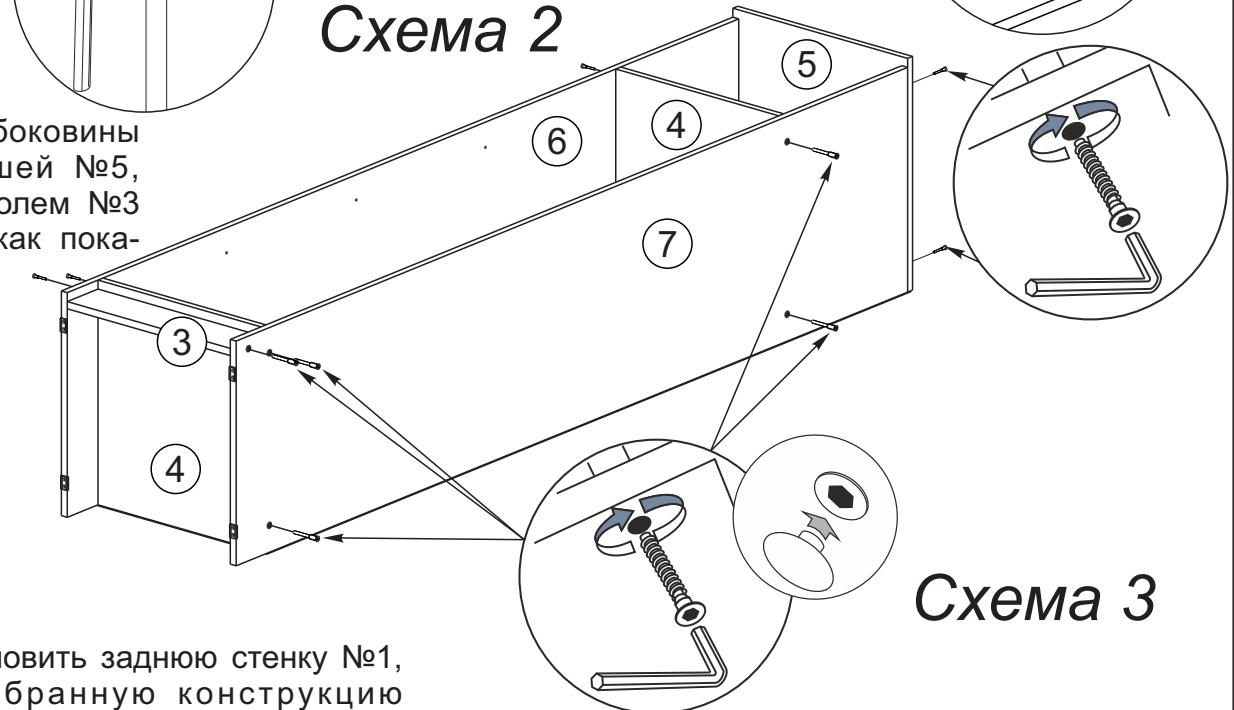
3. Чтобы установить заднюю стенку №1, необходимо собранную конструкцию перевернуть лицевой стороной вниз. Замерить, с помощью рулетки, и уравнять диагонали, наложить заднюю стенку.
